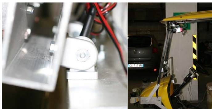
Figura 32 – Le fotografie mostrano due particolari del montaggio della testa stereo: a sinistra i giunti snodati utilizzati per fissarla, mentre a destra la posizione di montaggio su USAD.
