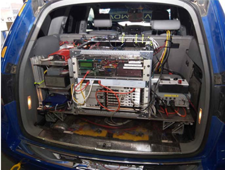
La figura mostra il bagagliaio del veicolo "Junior" creato dalla Stanford University. Com'è possibile osservare, la quantità di dispositivi e connessioni è molto elevata e per questo motivo è opportuno che ogni risorsa sia ottimizzata nel migliore dei modi.
