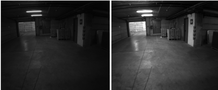
Figura 42 – Le coppie di immagini sopra riportate mostrano il risultato della sola operazione di pixel-binning. A sinistra è mostrata l'immagine del sensore (cioè con binning 1x1) e a destra il risultato dell'operazione (con binning 4x4).
