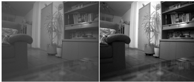
Figura 14 – Le due immagini mostrano l’importanza del contrasto: quella di sinistra è scarsamente contrastata e per questo motivo è difficile riconoscere ed identificare i dettagli della scena. Quella di destra, invece, è ben contrastata ed possibile riconoscere chiaramente gli oggetti dallo sfondo ed i più piccoli dettagli
