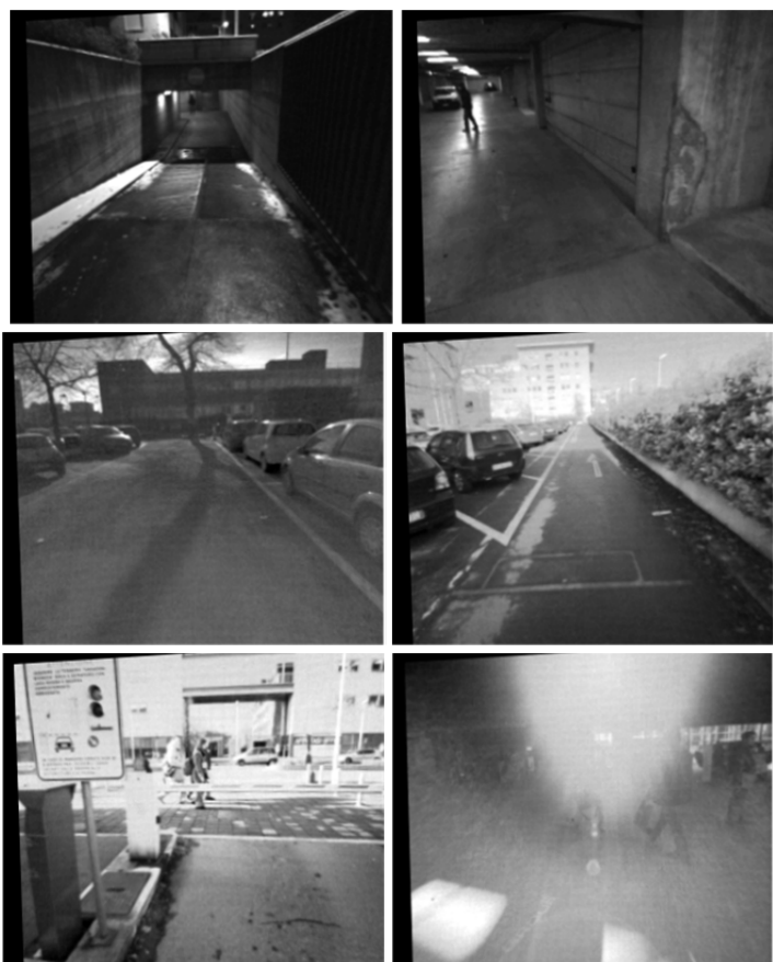
Figura 44 – Nelle immagini sopra sono rappresentati alcuni casi significativi acquisiti durante differenti orari del giorno e diverse condizioni metereologiche e di luce. Com'è possibile notare, tutte le immagini sono ben contrastate e sufficientemente luminose. Nell'ultima immagine è possibile osservare un tipico problema delle ottiche quando una "lama" di luce colpisce il vetro, rendendo cieca la camera.
