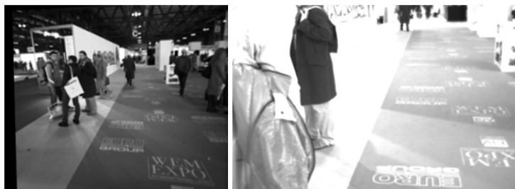
Figura 41 – Le immagini mostrano la stessa scena ripresa da due camere differenti: una dotata di LinLog, a sinistra, e l'altra senza questa tecnologia, a destra. Il diverso campo visivo è causato dalla differenza lunghezza di focale delle ottiche utilizzate.
