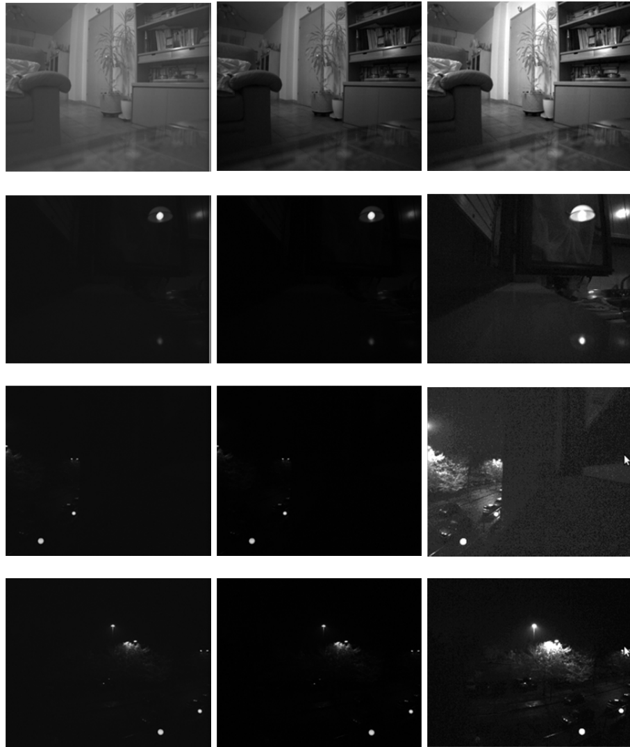
Figura 43 – Le triplete di figure sopra riportate mostrano: a sinistra l'immagine originale del sensore, in centro l'esecuzione dell'equalizzazione dell'istogramma "tradizionale" e a destra l'equalizzazione dell'istogramma utilizzando stretchlim.
