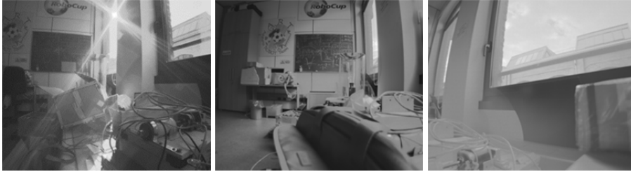
Figura 40 – Le fotografie mostrano il risultato della tecnologia LinLog in una situazione molto sfavorevole. Sono state catturate in IraLab in condizione di forte controluce con sole estivo diretto attraverso la finestra. La rimanente parte di laboratorio non era illuminata da luce artificiale ed era quindi mediamente buia. Le condizioni di acquisizione sono le medesime.
