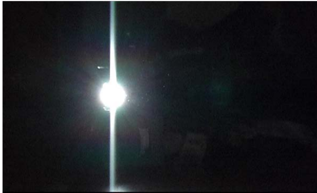
Figura 2 – La figura mostra il tipico effetto di “smearing” dei sensori CCD esposti ad una forte fonte luminosa.
