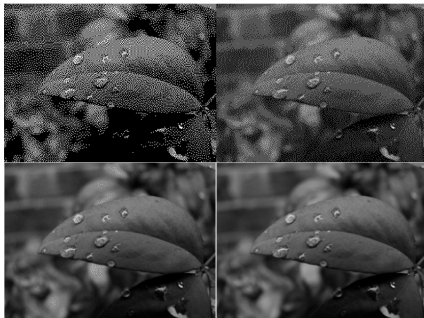
Figura 13 – Le immagini sopra, da sinistra a destra e dall’alto in basso, rappresentano la stessa immagine in cui ogni pixel ha diverse profondità colore, rispettivamente 1bit (2 livelli), 2bit (4 livelli), 4bit (16 livelli) e 8bit (256 livelli).
