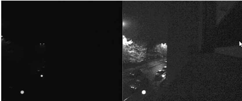
Figura 35 – Le fotografie mostrano, a sinistra, l'immagine catturata dal sensore della camera e, a destra, la stessa immagine a cui è stato applicato l'algoritmo di binning 4x4, software sviluppato per questa tesi. Come appare evidente, l'immagine è "estrema" come condizioni di acquisizione, ma nell'immagine risultante è possibile distinguere un elevato numero di dettagli.
