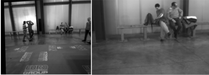
Figura 22 – Le immagini mostrano la stessa scena vista con due ottiche differenti. La prima (a sinistra) è l'ottica grandangolare pentax, mentre la seconda (a destra) è un'ottica non grandangolare con una distanza focale più ampia. E' possibile notare la grande differenza di campo visivo introdotta dalle due lenti.
