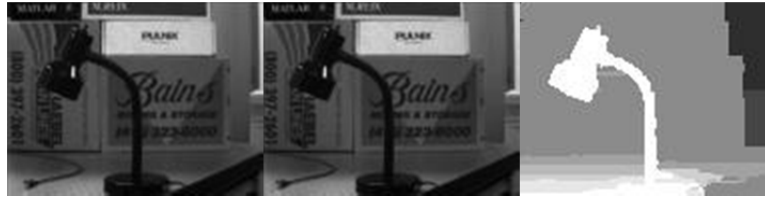
Figura 17 – Viene mostrato, da sinistra a destra, l’immagine catturata dalla camera di sinistra, l’immagine catturata dalla camera di destra e la mappa di disparità tra queste due immagini, opportunamente riscalata per essere visualizzata. Valori alti (colori chiari) corrispondono a grandi differenze tra le due immagini, mentre valori bassi (colori scuri) corrispondono a differenze minime. Più gli oggetti sono vicini alle camere, maggiore sarà la differenza che i due dispositivi osserveranno e più elevato sarà il valore della mappa di disparità.
